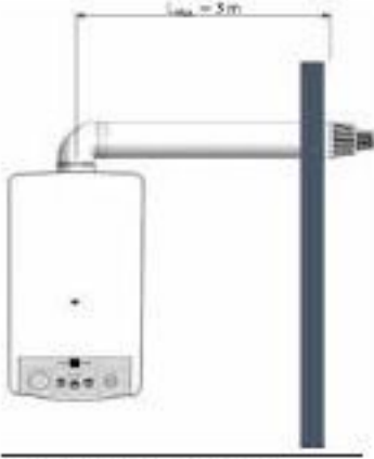
Yatay Hermetik Baca Uygulaması (Tek Döşeme L_max Mesafesi : 3 m, Ø 60/100)
