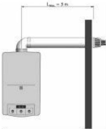
Yatay Hermetik Baca Uygulaması (Tek Dirsizde L mes Mesafesi : 3 m, φ 60/100)
